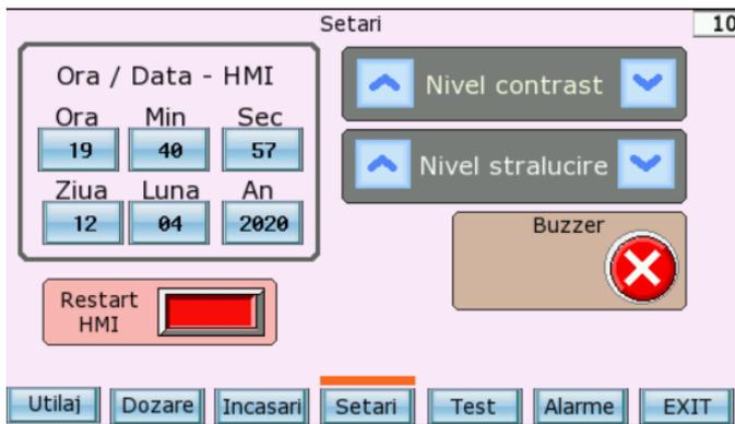
In acest ecran sunt setari pentru ora si data, activare /dezactivare buzzer si restart HMI. Instalatia fiind montata afara e recomandat sa nu se umble la contrast si luminozitate! **ATENTIE! HMI-UL NU TREBUIE SA STEA IN LUMINA DIRECTA A SOARELUI!**
