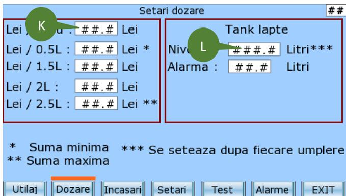
In acest ecran se trece pretul pe litru de lapte **K**, valorile urmatoare rezulta din calcul. La fiecare umplere a tank-ului se va masura cantitatea, cu rigla din dotarea utilajului, se va inscrie in caseta de nivel **L**. **NU UITATI SA REPETATI PROCEDURA LA FIECARE UMLERE!!!**
